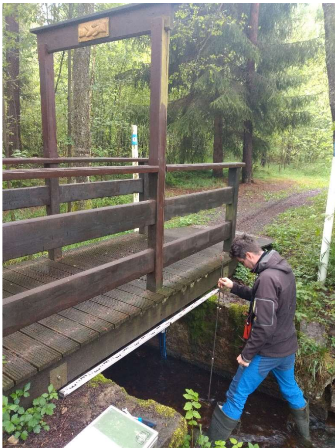
Obrázek 23. Hydrometrování na Újezdském potoce
